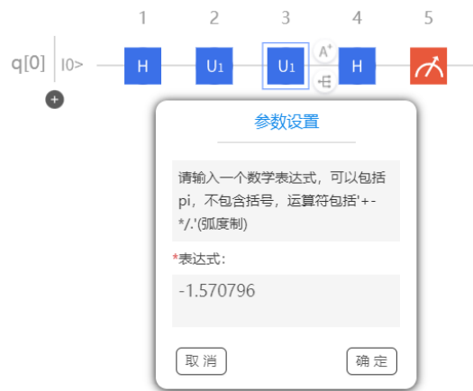
图 2.4: 调整相位测量正弦值的电路示例
