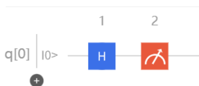
图 1.2: 一个简单的单量子电路
